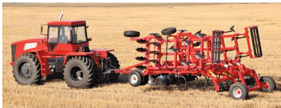
Рабочие органы: два ряда тяжелых дисков диаметром 560мм и три ряда культиваторных лап шириной 375 мм
