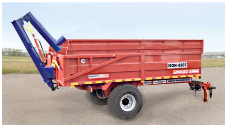
«ISON-8507» с собственным шнеком загрузчиком.
