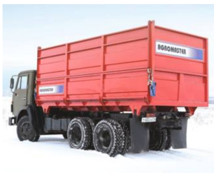
Имеет увеличенный объем кузова и увеличенную высоту основного и надставных бортов.
