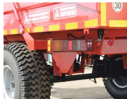
Оборудован пневматическим тормозом и светосигнальным оборудованием.
