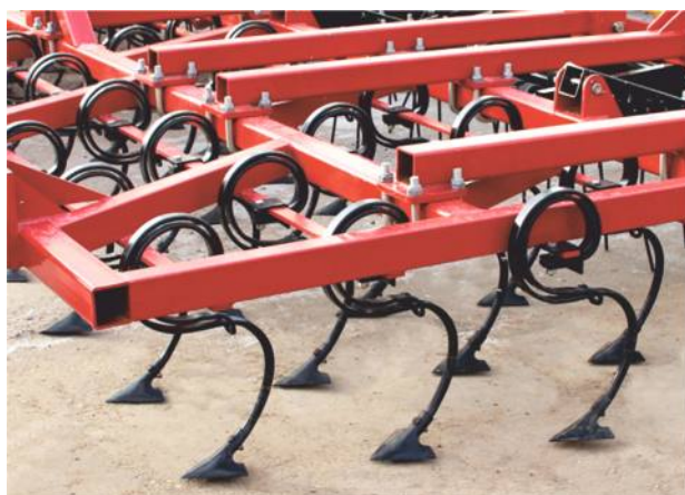
Четыре ряда культиваторных лап на пружинных стойках.
