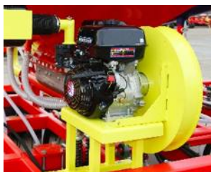
Привод вентилятора может быть от бензинового или дизельного двигателя или от гидромотора
