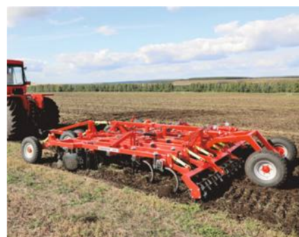
Рабочие органы: два ряда тяжелых дисков диаметром 560мм и три ряда культиваторных лап шириной 375 мм
