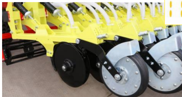
Вариант с индивидуальными прикатывающими колесами, расстояние между лентами посева 15 см
