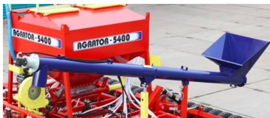
Собственный шнек-загрузчик позволяет работать без специального загрузчика семян и удобрений. Для загрузки бункера достаточно самосвала.
