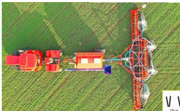
Вариант без прикатки, расстояние между лентами посева 15 см
