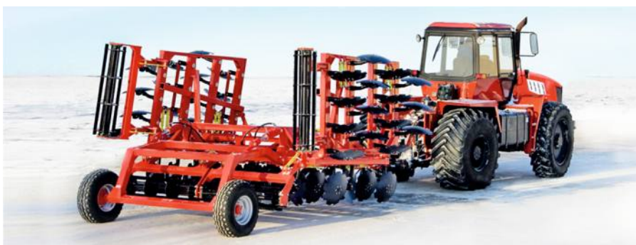
Каждый обрабатывающий диск установлен на индивидуальной вертикальной стойке с наклоном
