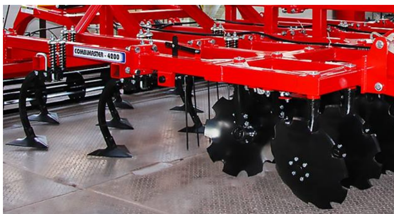
Рабочие органы: два ряда тяжелых дисков диаметром 560мм и три ряда культиваторных лап шириной 375 мм
