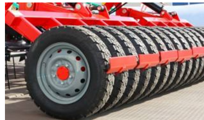
Прикатывающее устройство обеспечивает благоприятный контакт семян с почвой
