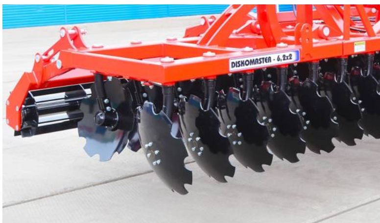
Каждый обрабатывающий диск установлен на индивидуальной вертикальной стойке с наклоном
