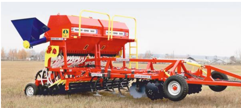
Agrator Combi - 3600. Вариант прикатывания с помощью опорно-прикатывающих пневматических шин.
