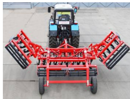
Каждый обрабатывающий диск установлен на индивидуальной вертикальной стойке с наклоном
